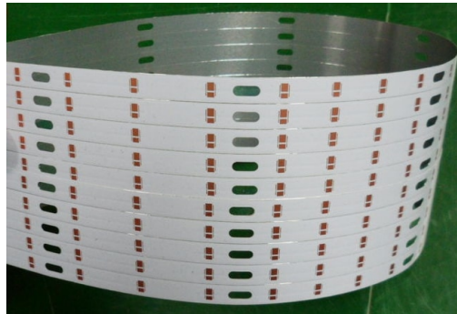
PCB (Printed circuit board) avant l'installation des résistances et des leds SMD
